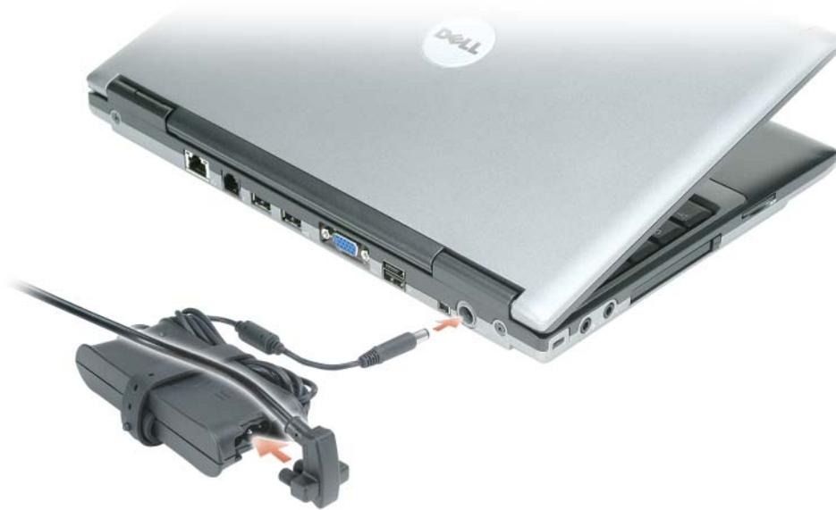
Der Netzadapter wandelt Netzstrom (Wechselstrom) in den vom Computer benötigten Gleichstrom um. Sie können den Netzadapter bei ein- oder ausgeschaltetem Computer anschließen.
