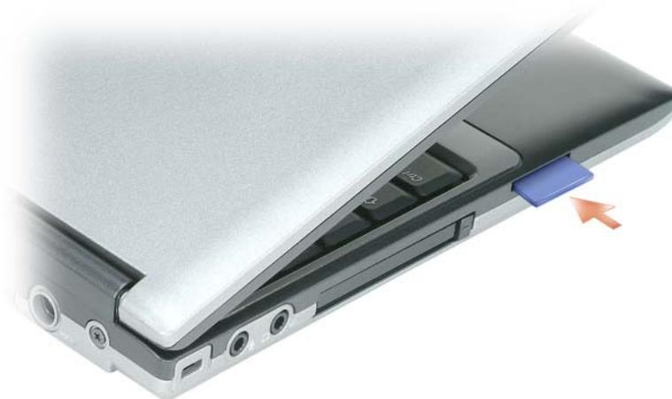
Um eine Secure Digital-Karte zu entfernen, drücken Sie in Richtung des Einschubs gegen die Karte. Diese springt daraufhin aus ihrer Halterung nach außen. Entfernen Sie die Karte aus dem Computer.
